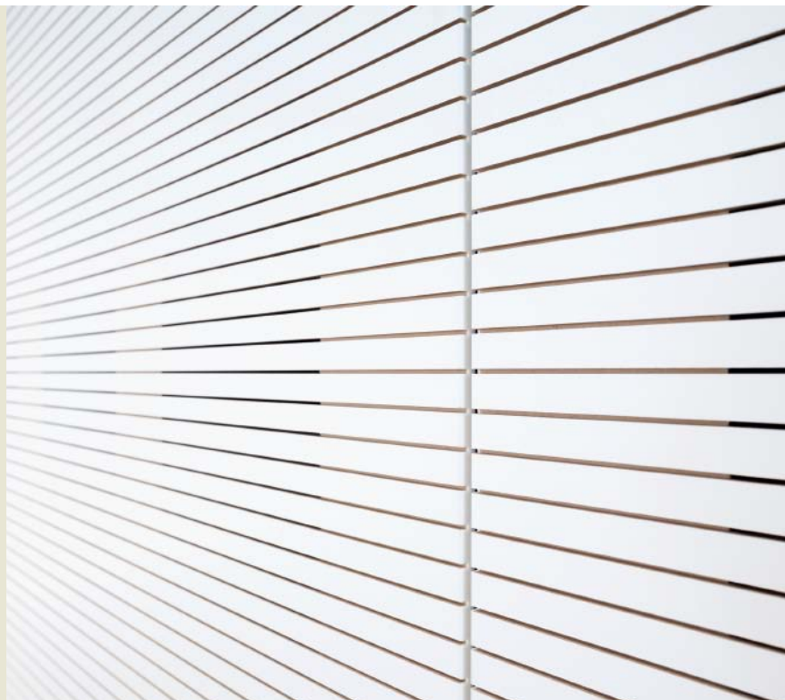
Vollwände mit Schallabsorption. Die Akustikelemente aus 19 mm starken MDF-Platten in horizontaler Schlitzung 14/2 (2 mm Schlitz und 14 mm Steg) sind akustisch wirksam.
