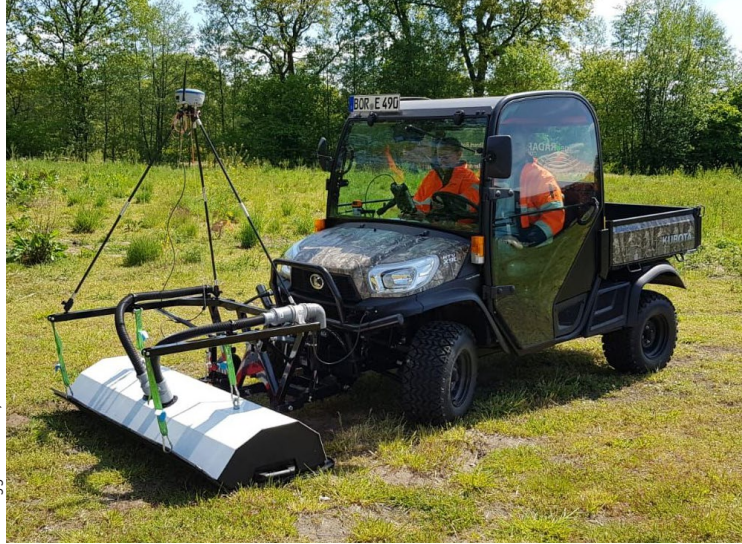
Flächensondierung mithilfe des Array-Systems
