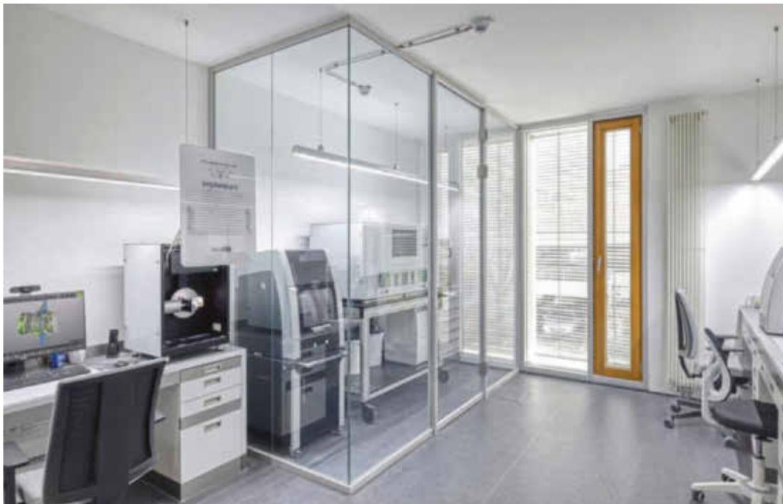
Die Präzisionsfräse wurde eingehaust mit Nurglaskonstruktion für weniger Staub- und Schallausbreitung.
