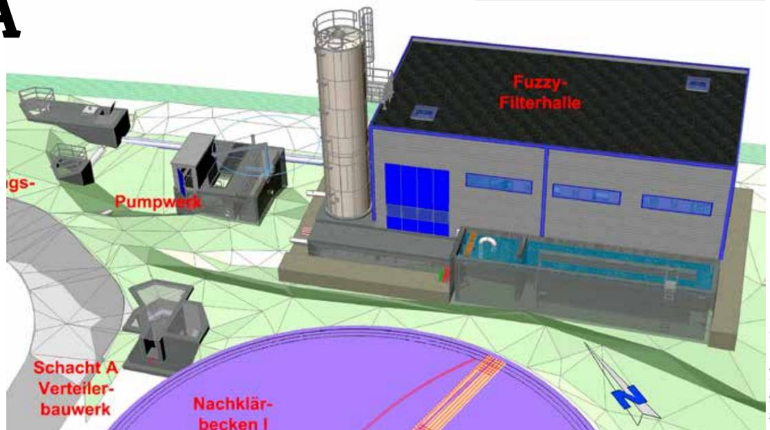
3D-Übersicht der vierten Reinigungsstufe. Durch die automatisierte AVA-Ankopplung entsteht in dem Projekt ein kaufmännisches Gebäudemodell.
